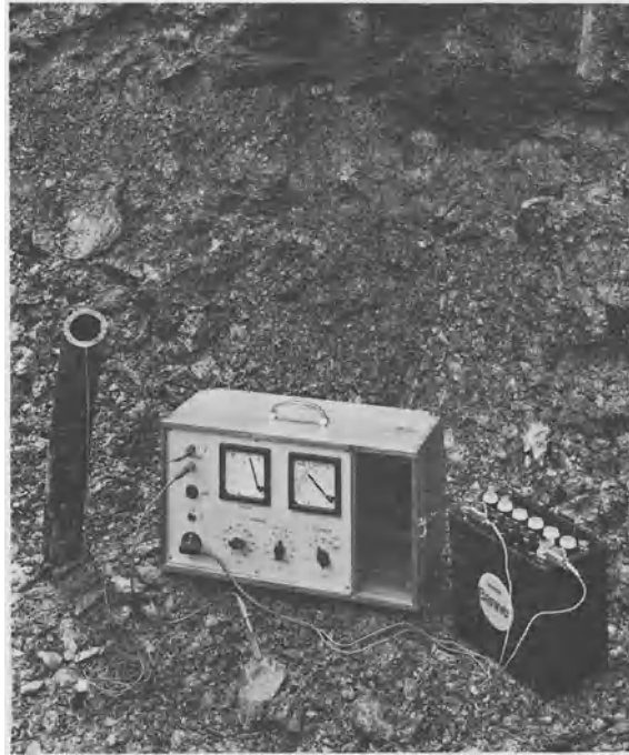
Abb. 7.8. Am Beginn des Bohrloches aufgestellter Gleichspannungswandler
